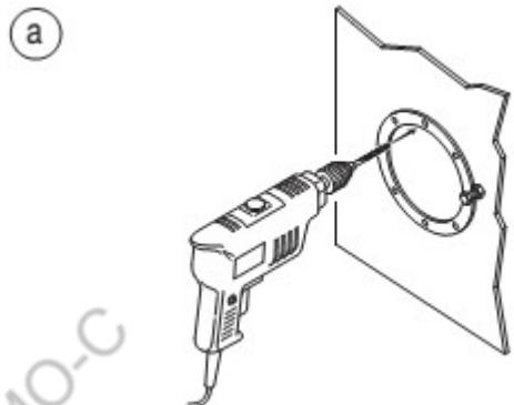
б). Определите местонахождение центра входа трубы, отметив линии, которые сочетают в себе диаметрально противоположные отверстия. Просверлите (пробурите) входное отверстие для прохода трубы.
