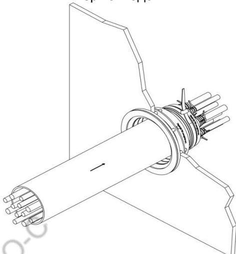
g) Вставьте кабель. (рис А). Затяните хомутом, что бы получить герметичное уплотнение между кабелем и гермовводом.
