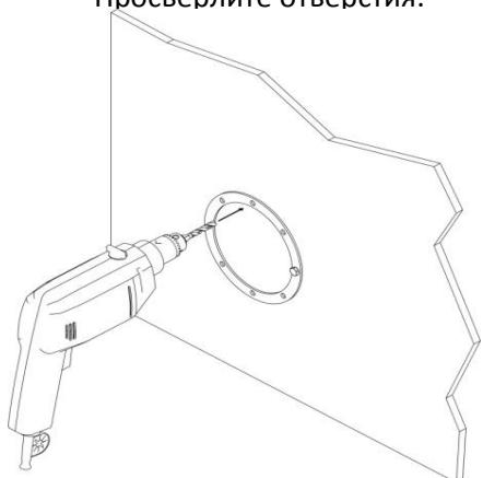
с) Установите гермовод с внешней стороны. Вставьте винты в соответствующие отверстия
