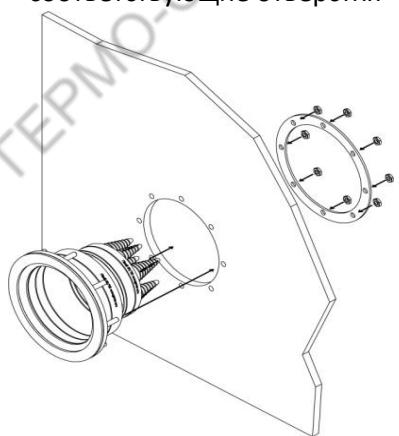
е) Вставьте кабель. (рис А). Затяните хомутом, что бы получить герметичное уплотнение между кабелем и гермовводом.
