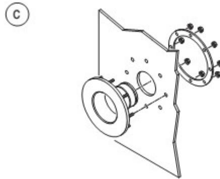
д). С внутренней стороны вставьте фланец (кольцо) и затяните гайки.
