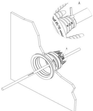
h) Штангенциркулем измерьте диаметр кабеля(рис А). Ножницами обрежте необходимый диаметр. (рис Б).
